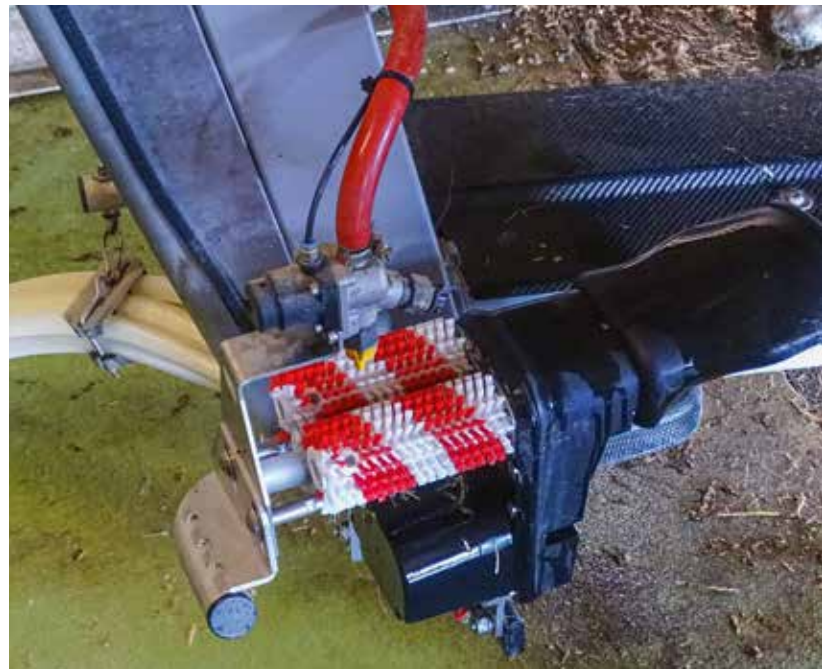
Es gibt mehrere Arten von Sprühdüsen. Diese Schlitzdüse war bei Landwirt B. auf dem Betrieb verstopft.
